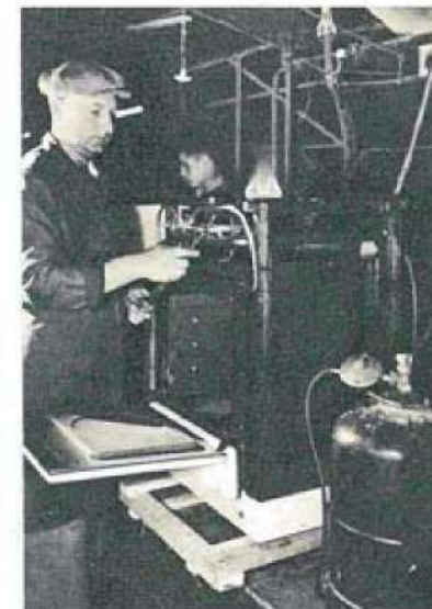
Essai général des cuisinières en fin de chaîne de montage.
