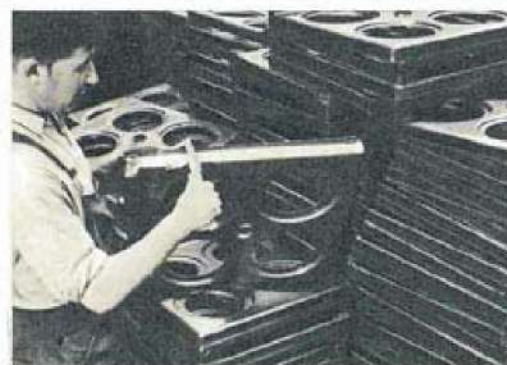
Contrôle des pièces de tôle d'acier des cuisinières après emboutissage.
