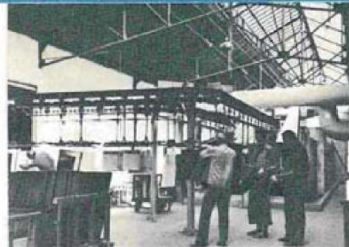
Contrôle des pièces émaillées à la sortie du tunnel d'émaillage en continu.
